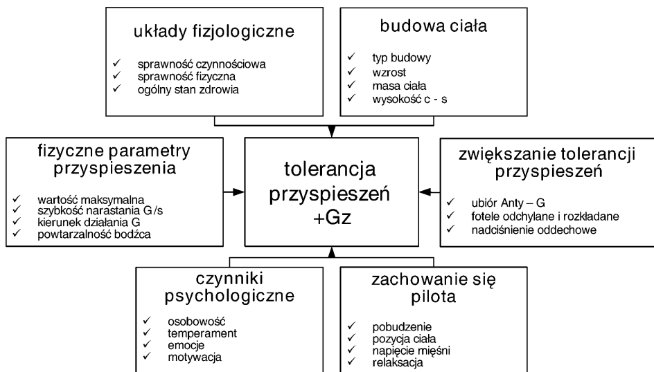
Ryc. 5. Czynniki wpływające na tolerancję pilota na przyspieszenia +Gz
